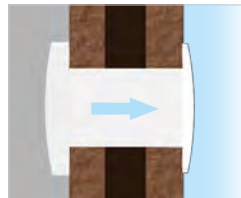
krátké odvodní potrubí
